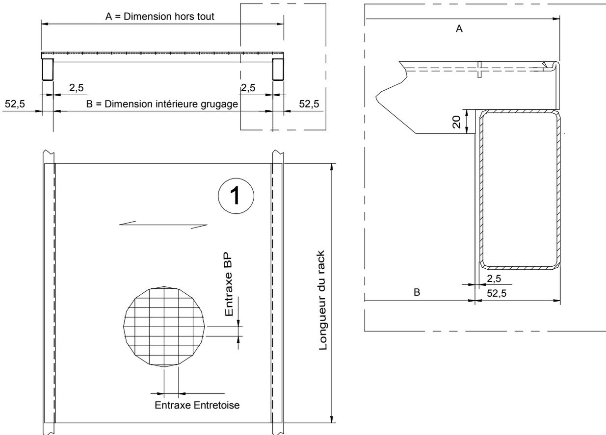
!!!! La maille et la barre porteuse sont à déterminer en fonction de la charge admissible !!!!
